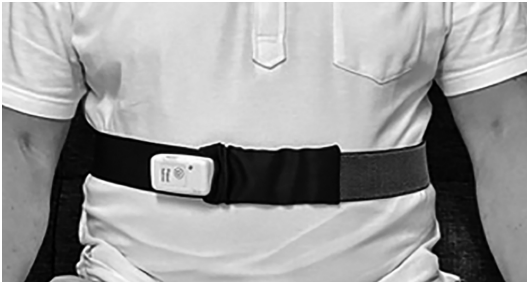
図2 CNT ヤーン歪センサー織物テープを組み込んだ呼吸センサーベルト
