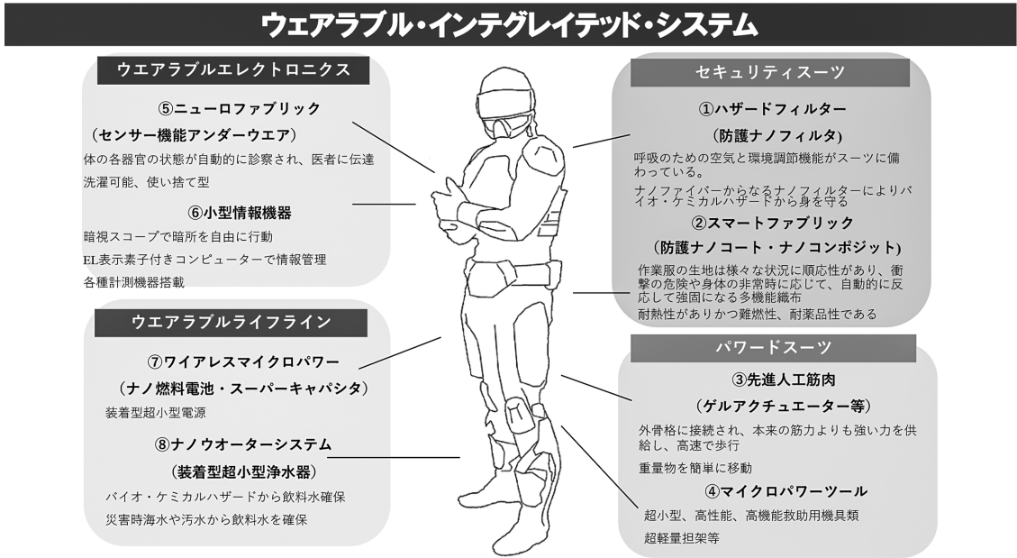
図3 ウェアラブル・インテグレイテッド・システムの概要
